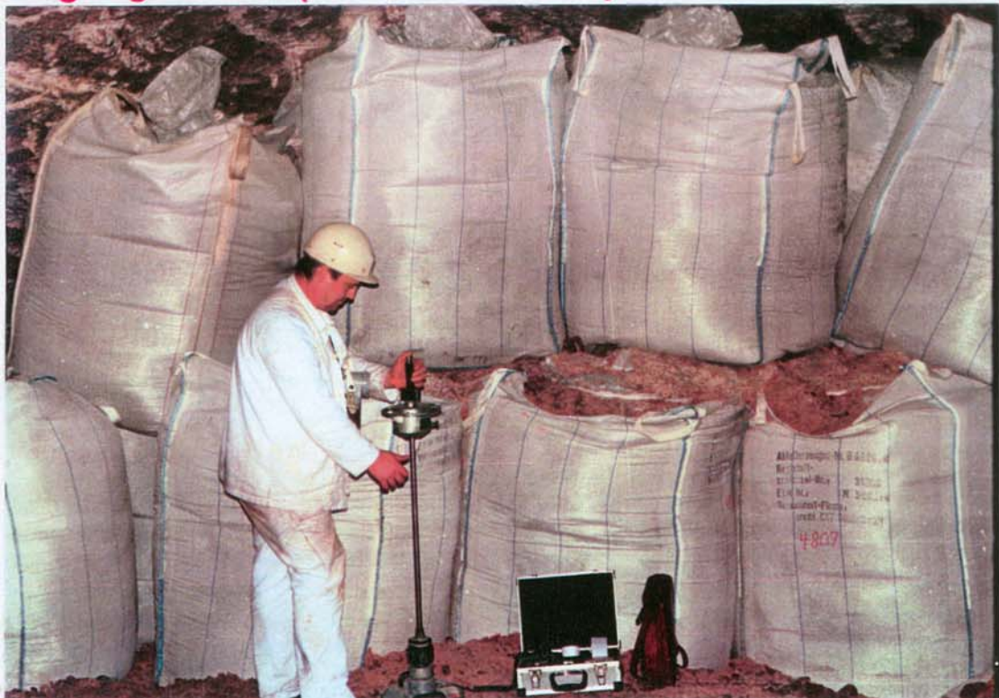
Abbildung 5 Durchführung eines Lastplattendruckversuches im Big-Bag-Versatz
