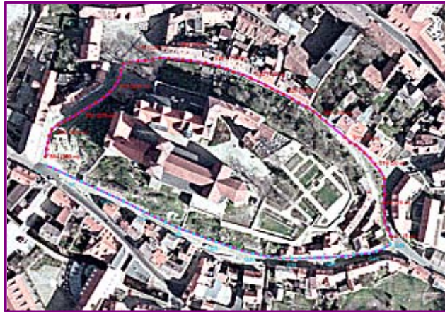
Luftbildaufnahme des Schlossberges // Lage der Geophone (blau) und Schlagpunkte (rot)
