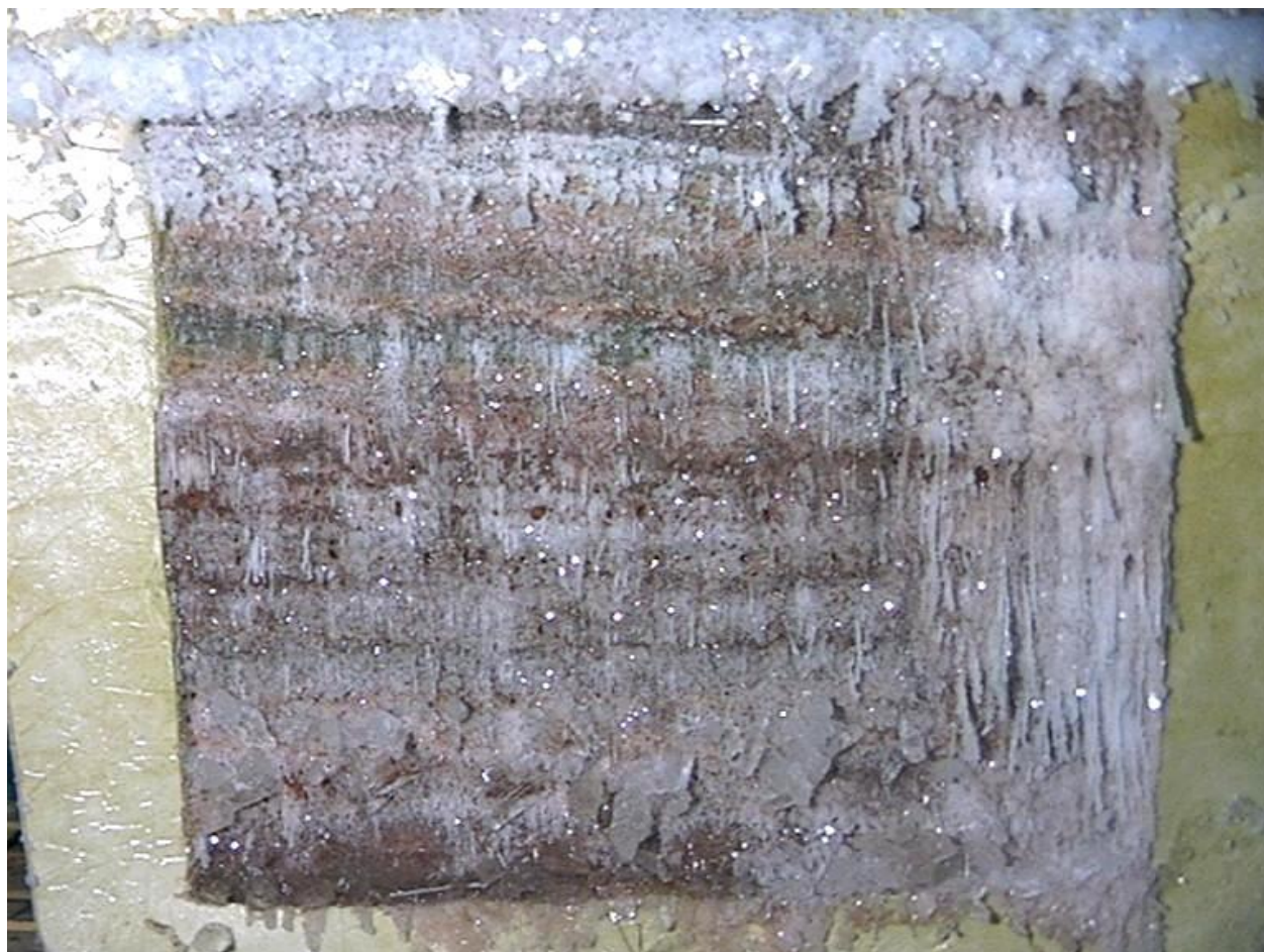
Abbildung 3: Block aus geschichtetem Carnallit nach der Versuchsdurchführung
