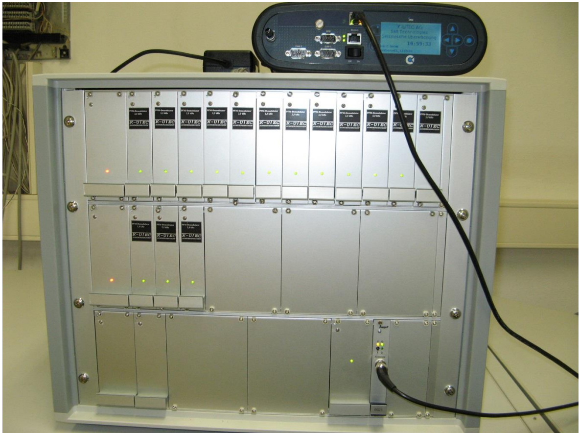
Demodulationseinheit mit integriertem Transientenrekorder
