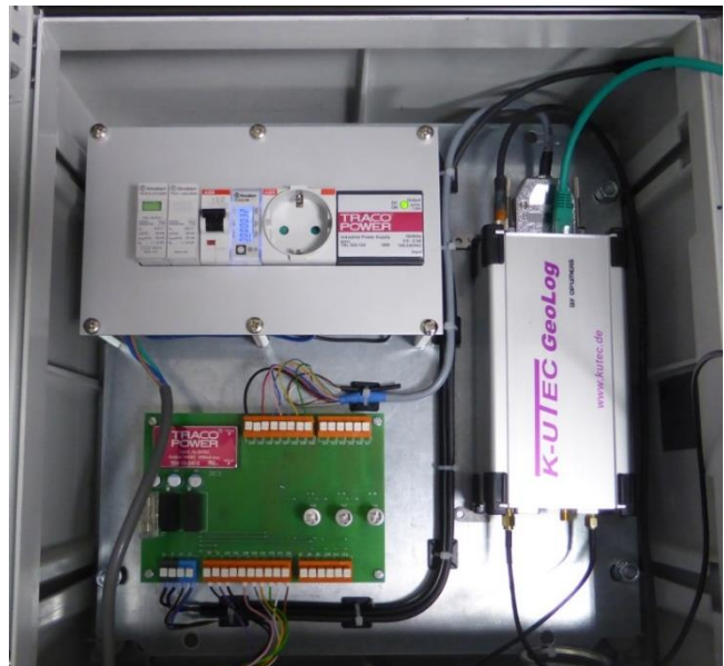
Datenstation mit Solarstromversorgung und 4G-Datenverbindung
