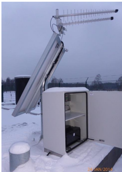
Datenstation mit Solarstromversorgung und 4G-Datenverbindung
